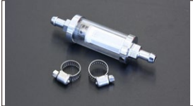
●マグネット付燃料フィルター 本体 ¥3,500 *分極清掃可能なガラス管タイプのフィルターで、内部に仕込まれたマグネットが分岐や鉄粉をキャッチします。(8mmホース用、ホースバンド2個付属)
