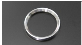
●WEBER40 ベンチュリー固定リング エアクリ用 本体 ¥1,000 エアクリナーを装着した際に発生するインナーベンチュリーとエアクリナーとの隙間を無くし、同時にベンチュリーをしっかりと固定します。(ファンネル固定タブが別途必要)
