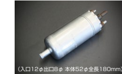
(入口12φ出口8φ 本体52φ全長180mm) ●3.1Lポッシュフューエルポンプ ¥55,500 *吐出量 3.1L/分 (L30~L32レース用) *大容量フューエルレギュレーター2個と8mmリターンパイプ2本で燃圧制御可能
