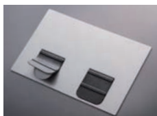
ワンウェイバルブによって オイルを中央に集める機構
