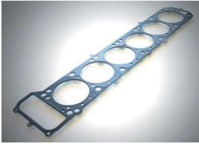
高いシール性を要求される燃焼室回りや、水穴とオイル穴の周囲にプレス加工によるビードを設けることにより、高面圧を確保するのがビードタイプです。
