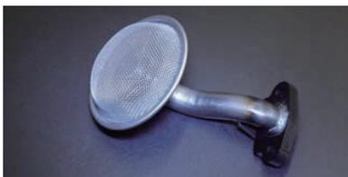
エンジン振動により発生するストレーナーのクラックは致命的なエンジントラブルにつながります。レーザーカットで作り上げた専用フランジと補強板の追加によって力のかかる付け根付近を強化した対策品です。
