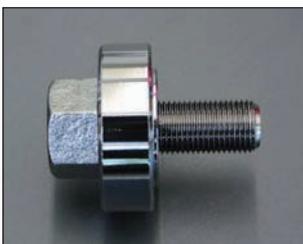
高回転時に発生するクランクシャフトのネジレ振動や曲がり振動は純正ボルトをどんなに強く締め込んでも結果的に緩んでしまいます。その結果、クランクプリーやオイルシールにまで被害が及び大きなエンジントラブルにつながる事があります。亀有強化クランクプリーボルトはボルトの緩みを防止しエンジンをトラブルから守ります。
