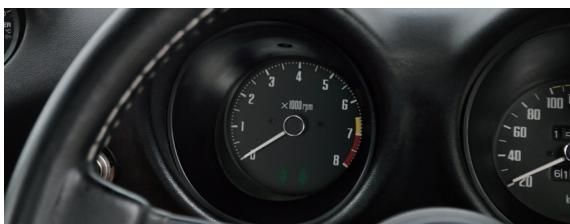
本製品は、文字板と指針部を純正と同じ形状に新規設計した部品に、高精度でハイレスポンスなステッピングムーブメントを組み込んだ旧車用タコメーターです。
