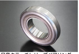
日産クラッチリリースベアリング 品番: 40751S ¥1,910 ■適合 (標準) L6 A型 FJ20 ※サイズ D=74.5 d=40 T=19 B=17 C=62
