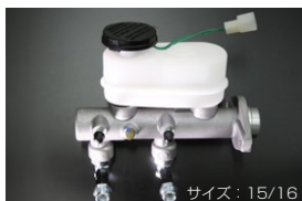
S130 ブレーキマスターシリンダー (後期 右ハンドル車用) サイズ: 15/16 適合: 81.10~83.8 (L20/L28) 価格: ¥49,000 ※パイプの取り付け位置が標準より6cm下がります。
