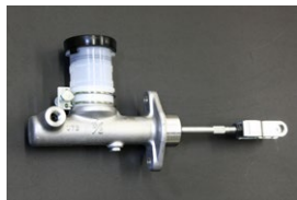
5/8クラッチマスターシリンダー (汎用タイプ) 適合: S30, GC110, C130, 510 価格: ¥12,900
