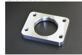
マスターバックスペーサー GC110後期の大容量マスターバックをGC10, GC110前期に装着する時に使用 価格: ¥5,000
