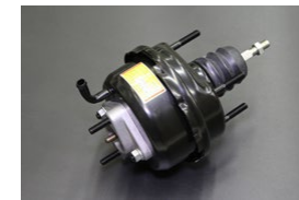
GC110 前期マスターバック サイズ: 外径143φ (ツメ部) ※スペーサー使用でハコスカ流用可 価格: ¥76,800
