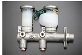
GC210 ブレーキマスターシリンダー サイズ : 7/8 (日産純正ナブコ製) 適合 : リヤドラム車 (L20E) (77.8~81.7) 価格 : ¥49,900
