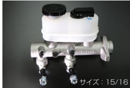
S130 ブレーキマスターシリンダー (後期 右ハンドル車用) サイズ: 15/16 適合: 81.10~83.8 (L20/L28) 価格: ¥42,000 ※パイプの取り付け位置が標準より6cm下がります。
