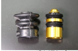
クラッチリリースリペアキット 品番：SX45004 サイズ：3/4 (ブーツ内径8φ) 適合：TA22, TA27 (48.4~48.12) 価格：¥2,500
