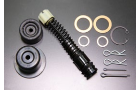
クラッチマスターリペアキット 品番：SX45003 サイズ：5/8 適合：TA22, TA27 (45.12~50.9) 価格：¥2,260
