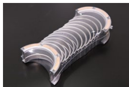
L6 純正0.5アンダーメインメタルSET 原動機：L20,L24,L28 適合：ジャーナルが0.5アンダーで スラストがSTDタイプ 価格： ¥14,000
