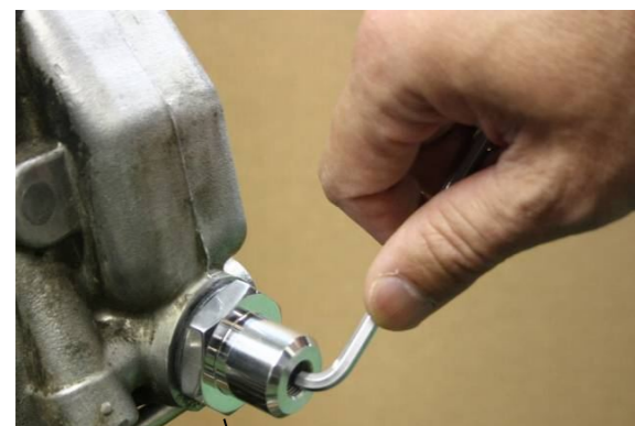
テンションアジャスター本体の締め付けトルク 500~550 (N・m) ※M32 ネジ部にオイル不用 / 付属のパッキン使用
